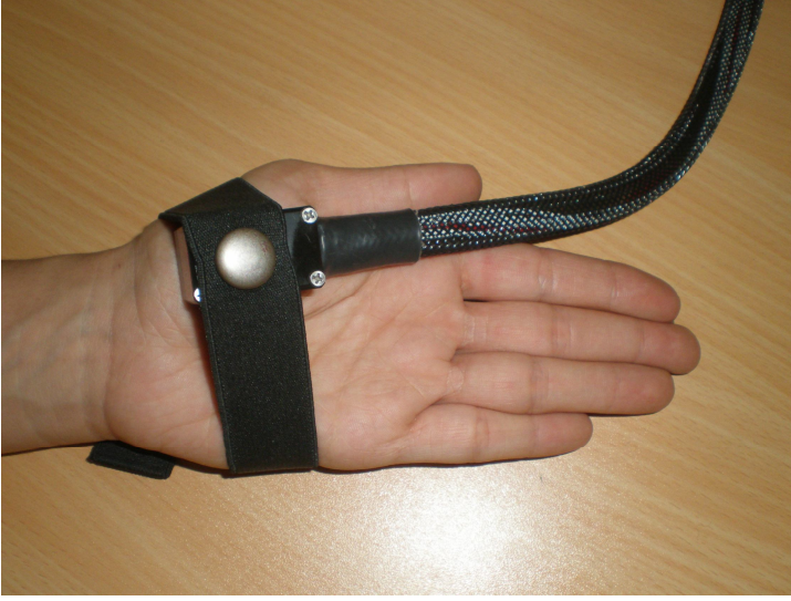
Şekil 3.2: Çalışmada kullanılan KDT aletinin 16 mm propu ve sol el C6 dermatomuna uygun bağlantı şekli
