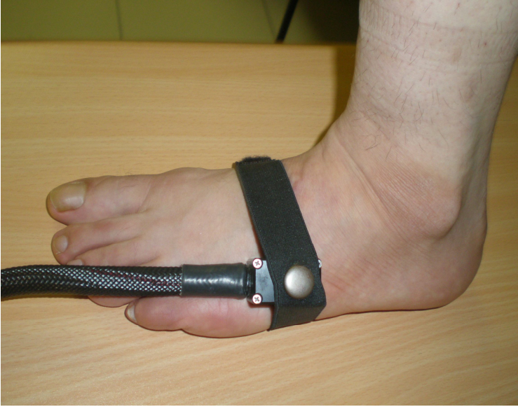
Şekil3.3: Çalışmada kullanılan KDT aletinin 16 mm propu ve sol ayak S1 dermatomuna uygun bağlantı şekli
