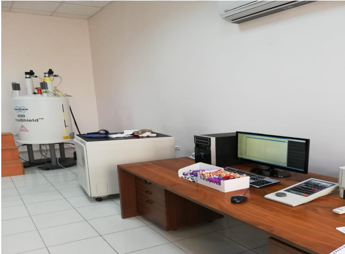
Şekil 3.1 Metabolite ölçümleri için kullanılan 400 MHz NMR cihazı ve kullanılan örnekler
