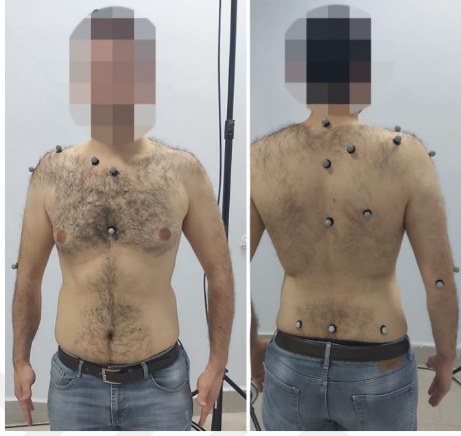
Şekil 3.2. Belirli anatomik noktalar üzerine yapıştırılan 16 adet pasif yansıtıcı
