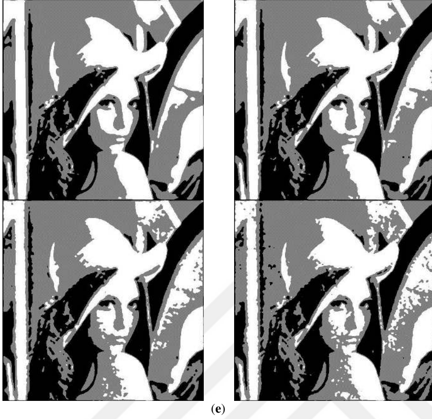
Şekil 6.6. “Lena” görüntüsündeki karşılaştırma sonuçları (a) Farklı Gauss gürültü seviyesine sahip “Lena” görüntüsü, varyans: 0, 10, 20, 30, (b) NBK bölütleme sonuçları, (c) ÇK bölütleme sonuçları, (d) ÇÇK bölütleme sonuçları, (e) NÇK bölütleme sonuçları
