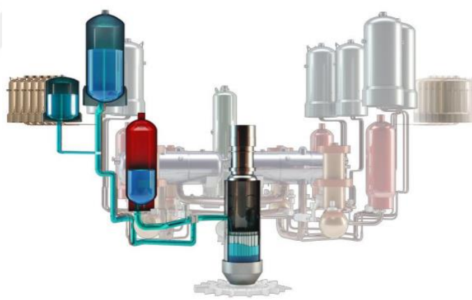
Şekil 3-15 Pasif Kor Su Basma Sistemi [49]
