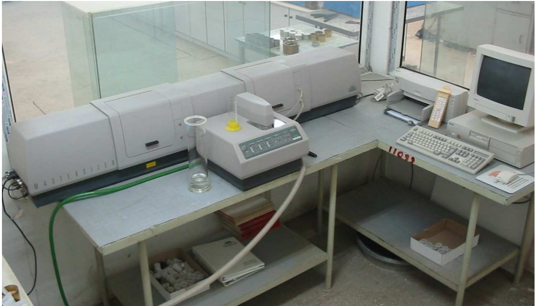
Resim 3.2. Malvern Master SizerX lazer kırınım cihazı (Gazi Ünv. Tekn. Eğt. Fak. Yapı Eğt. Böl.)
