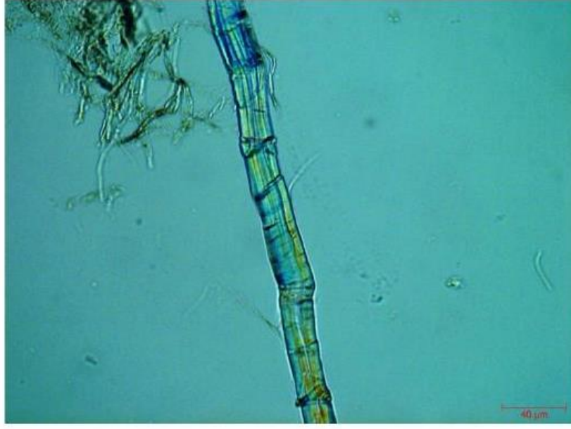
Şekil 1. Nuruosmaniye 3644'den alınan kâğıt lifi numunesi - polarize ışık, 500x
