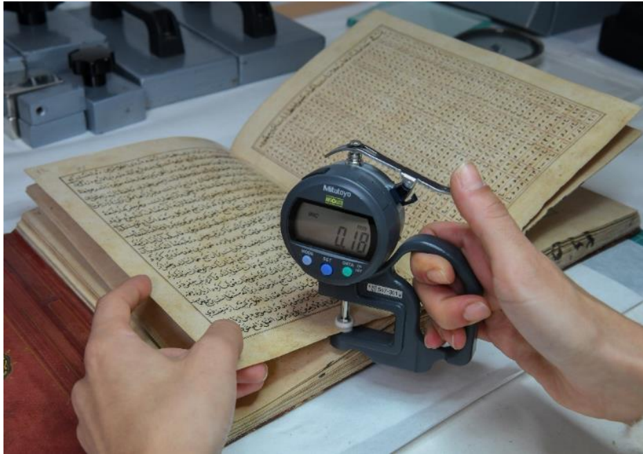
Şekil 65: NOYEK 3656: Mikrometre Ölçüm
