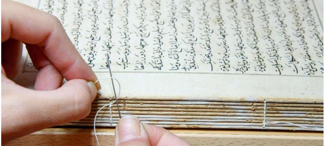
Şekil 119: NOYEK 3656: Sırt Dikişinde Düğüm Atılması
