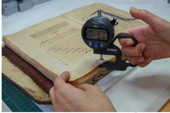
Şekil 23: NOYEK 3644: Mikrometre Ölçüm
