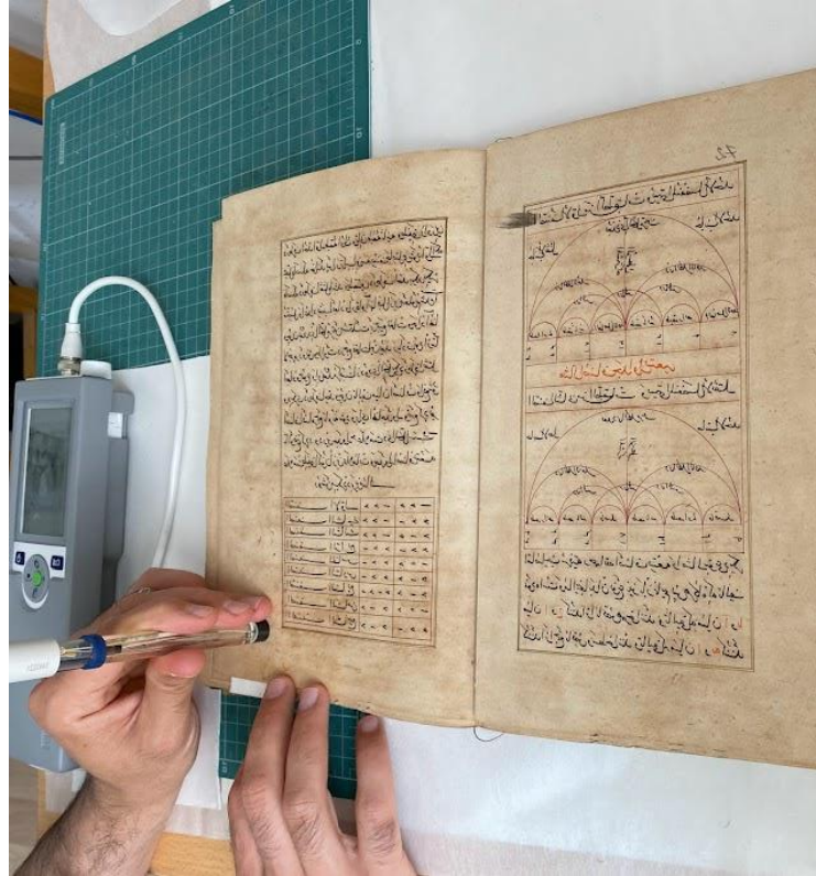
Şekil 71: NOYEK 3656: pH Ölçüm
