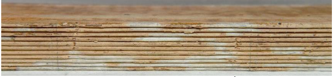
Şekil 118: NOYEK 3656: Sırt Dikişi Yerlerinin İşaretlenmesi
