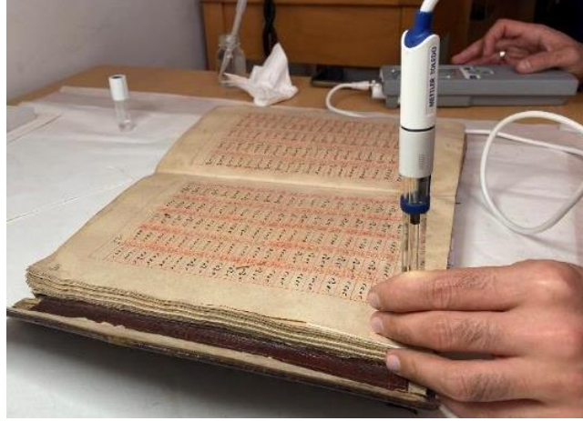
Şekil 41: NOYEK 3644: pH Ölçüm
