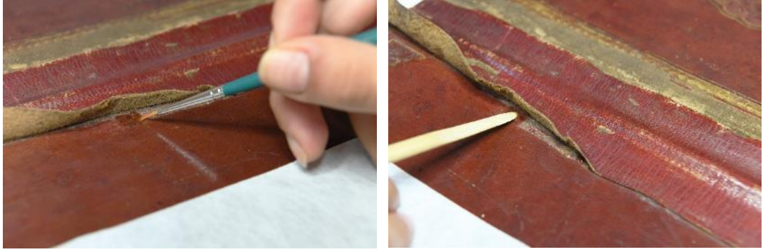
Şekil 95: NOYEK 3656: Eski Onarım Sırt Derisinin Nemlendirilip Kaldırılması
