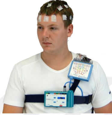
Şekil 3.3. 33 kanal SOMNOscreen Plus PSG cihazı [68]
