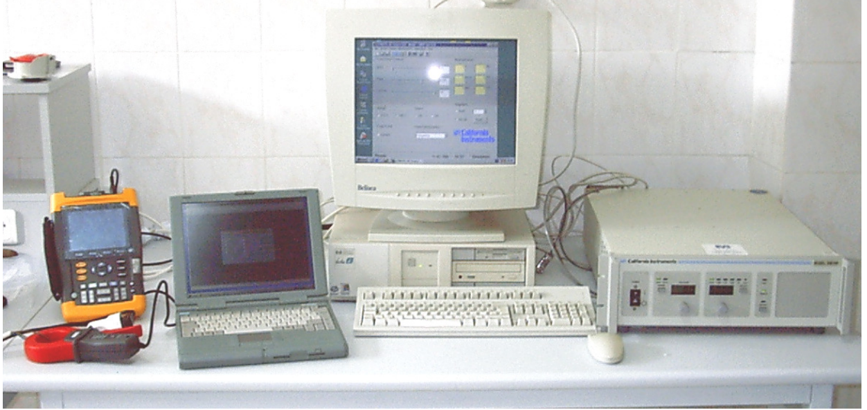
Şekil 3.2 Harmonik ölçüm düzeneğinin toplu görüntüsü
