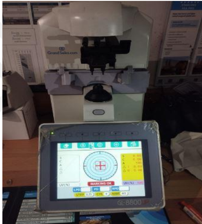
Şekil 3.1:GL-8800 UP dijital fokometre cihazı.
