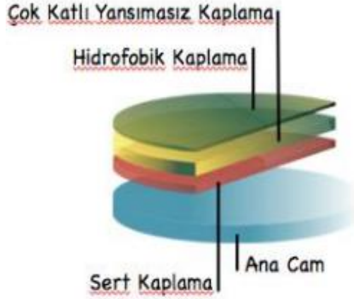
Şekil 2.14: Ana cam yüzeyine uygulanan sert kaplama(Aykut, 2019).
