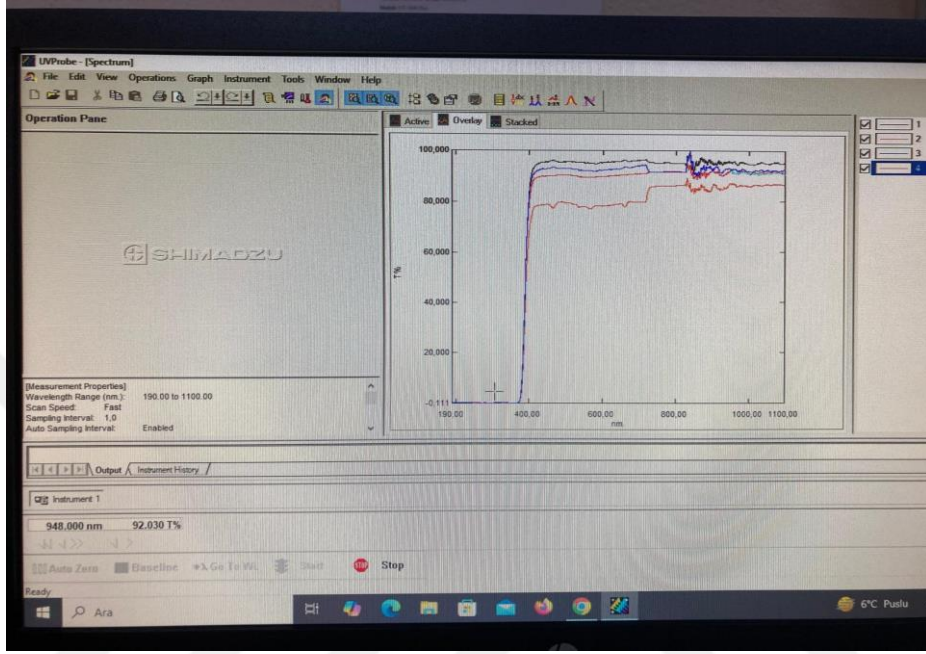
Şekil 3.6:UV-VISIBLE Spektrofotometre ışık geçirgenliği ölçümü.
