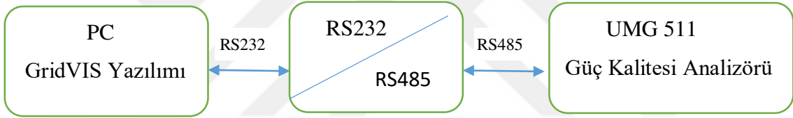
Şekil 3.1. UMG 511'in bir arayüz dönüştürücü kullanarak bilgisayara bağlantısı
