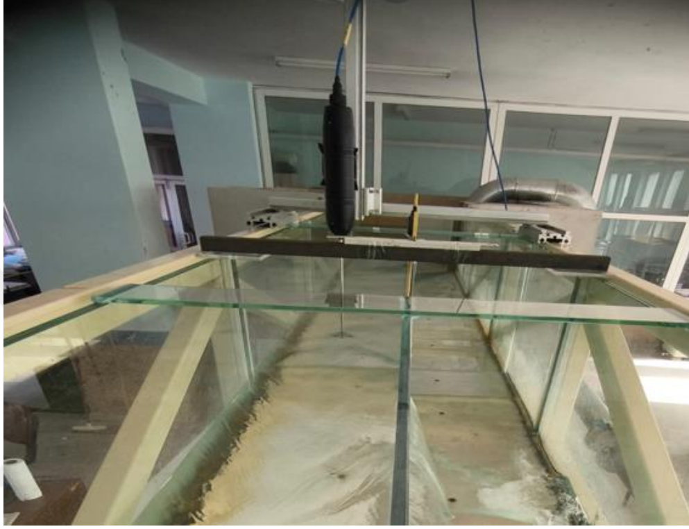
Şekil 3.8. Kanalda hız ve seviye ölçümleri (mansap tarafından görünüm)
