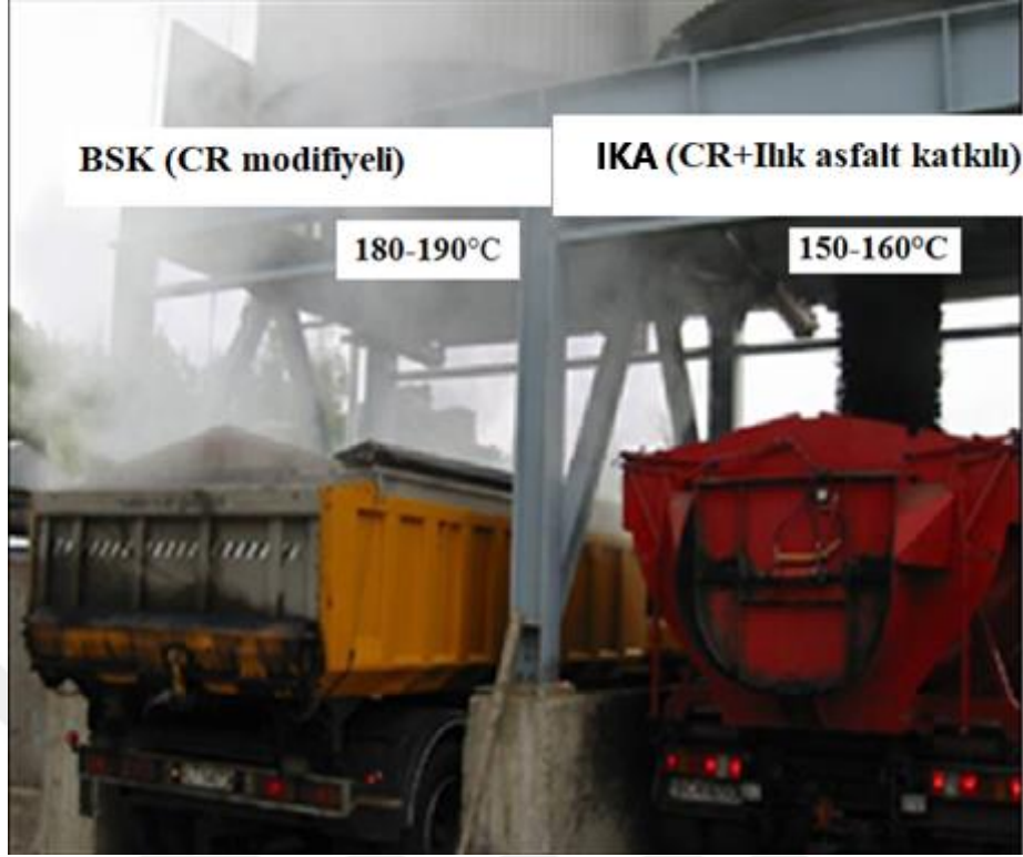
Şekil 3.1. BSK ve IKA karışımlarının üretim sırasındaki gaz salınımları
