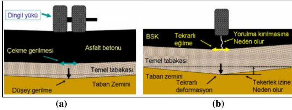
Şekil 3.9. Tipik Bir Esnek Üstyapısı (a) ve Oluşan Bozulmalar (b) [Karaşahin,2007].
