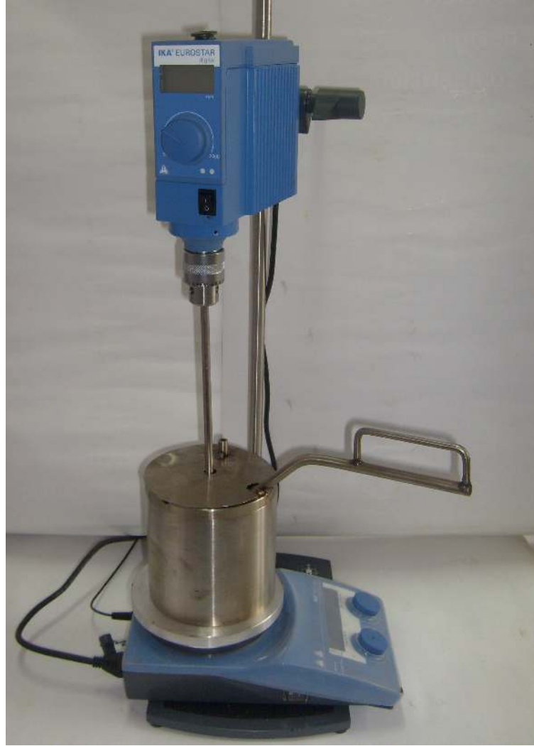
Şekil 6.5. Modifiye bitüm karıştırma cihazı
