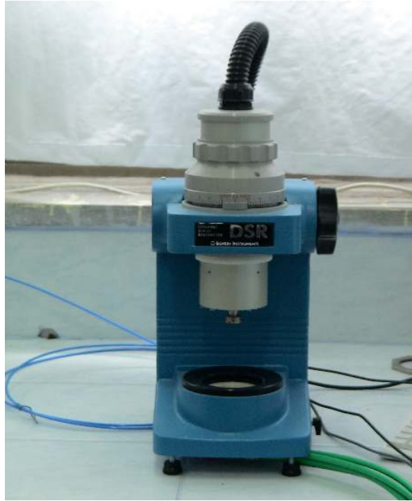
Şekil 5.3. Bohlin DSR II dinamik kayma reometresi
