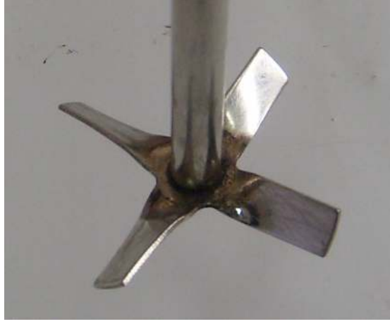
Şekil 6.4. Çalışmada kullanılan karıştırma mili
