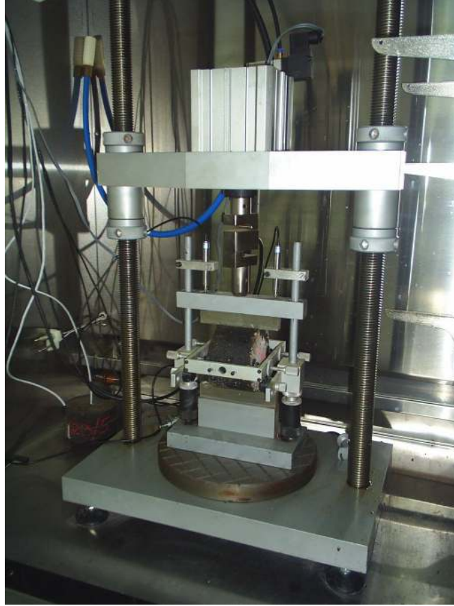
Şekil 5.11. İndirek çekme tekrarlı yorulma deney düzeneği
