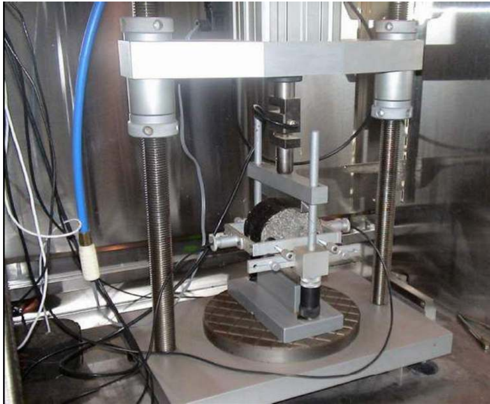
Şekil 5.12. İndirek çekme rijitlik modülü deney düzeneği
