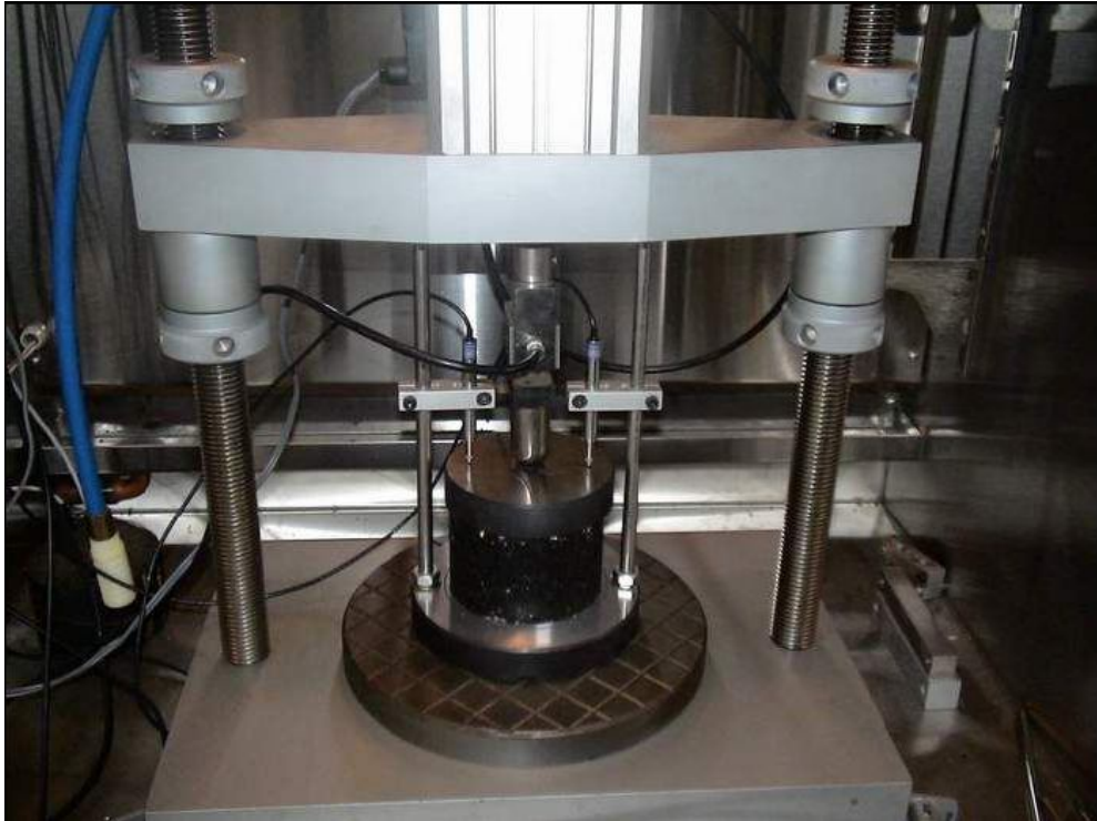
Şekil 5.10. Dinamik sünme deney düzeneği
