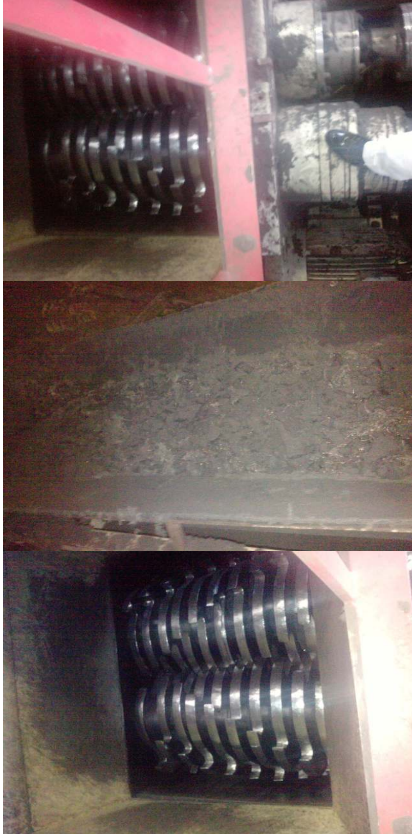
Şekil 6.1. Atık lastik öğütme süreci
