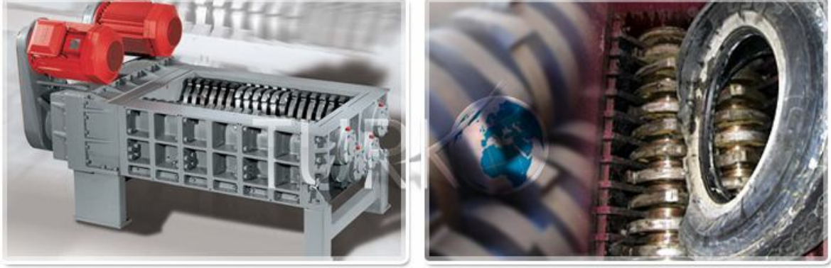
Şekil 4.8. Lastiğin mekanik olarak parçalanması [41].
