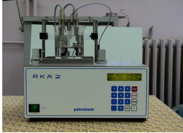
Şekil 5.2. Yumuşama noktası deney aleti
