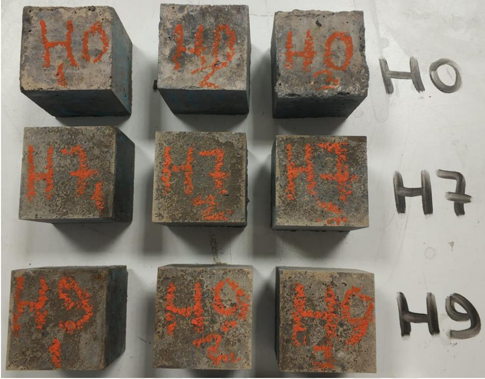
Şekil 6.31. 200 Devir sonrası bozulma görülmeyen numuneler
