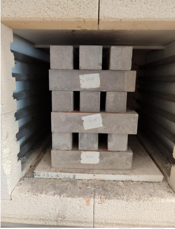
Şekil 6.22. Yüksek sıcaklık fırınındaki numuneler
