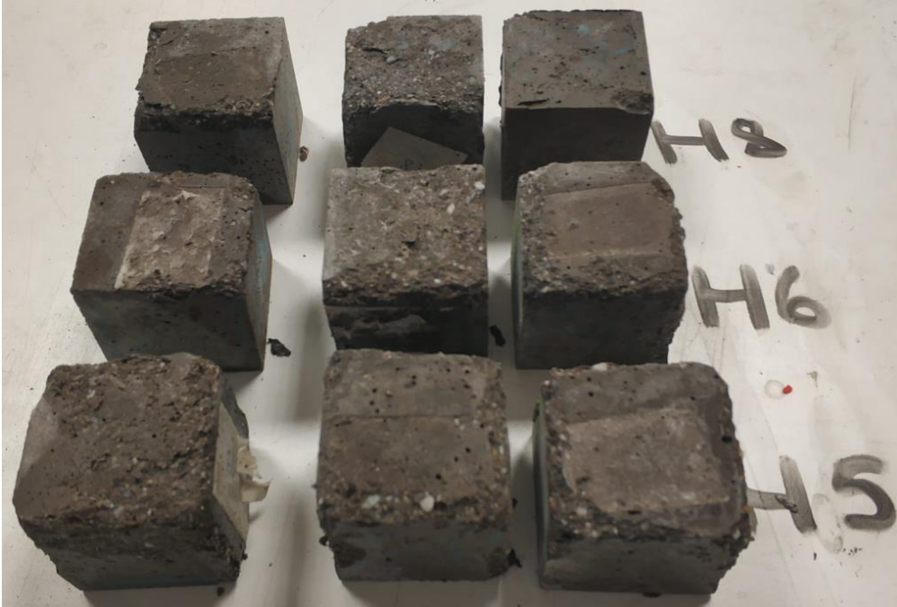
Şekil 6.32. 200 Devir sonrası bozulma görülen numuneler
