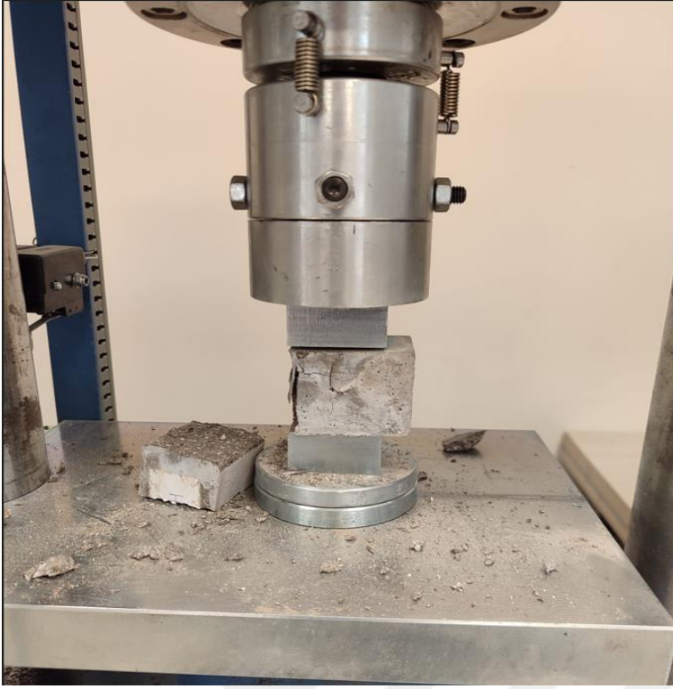
Şekil 6.18. Basınç testi yapılan numune
