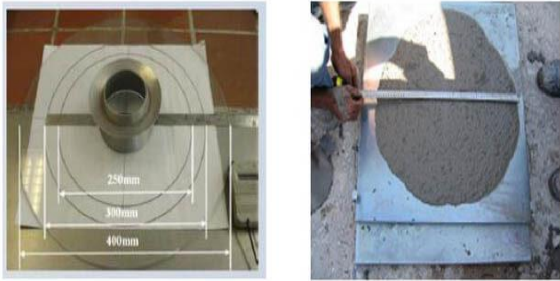
Şekil 2.2. KYB yayılma deneyi düzeneęi ve yapıma yöntemi (URL-3, 2025).
