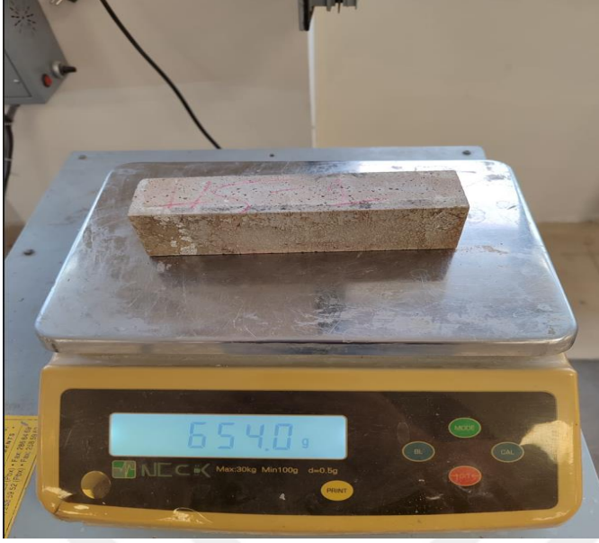
Şekil 6.26. Yüksek sıcaklık testi sonrası ağırlığı ölçülen numuneler
