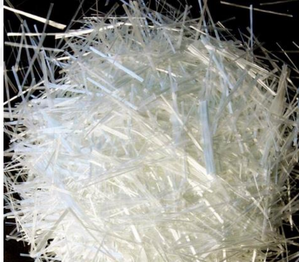
Şekil 3.4. AR kırılmış 12 mm cam elyaf.
