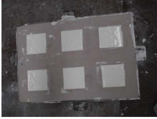
Şekil 3.17. Numunelerin kalıplara dökümü.
