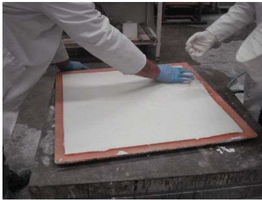
Şekil 3.15. Numunelerin premiks yöntem ile üretimi.
