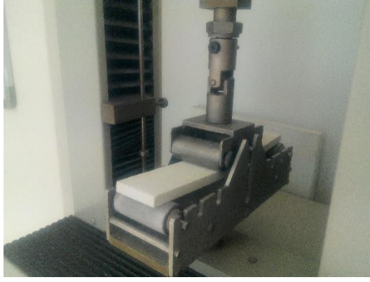
Şekil 3.16. Eğilme testinin gerçekleştirilmesi.
