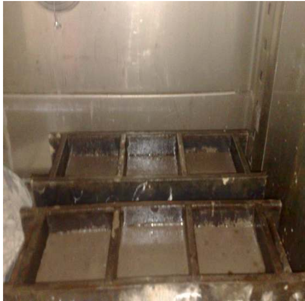
Resim 3.3 Sulu kıvamda gazbeton harcı kalıbın 2/3'ü dolacak biçimde dökülür (kabarma oluşmadan önce).
