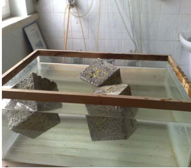
Resim 3.5 Etüvden çıkan malzemelerin gözenek kontrolü
