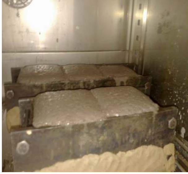
Resim 3.4 Akıcı kıvamda gazbeton harcının kabarmasıyla kalıbı doldurması.
