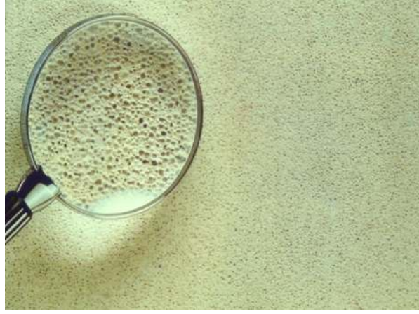
Resim 2.2 Gazbetonun gözenekli yapısının sembolik görünümü (İnt Kyn. 2)
