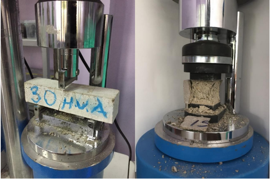
Şekil 4.18. Yüksek sıcaklık uygulanan numunelerin üç noktalı eğilme ve basınç deneyi
