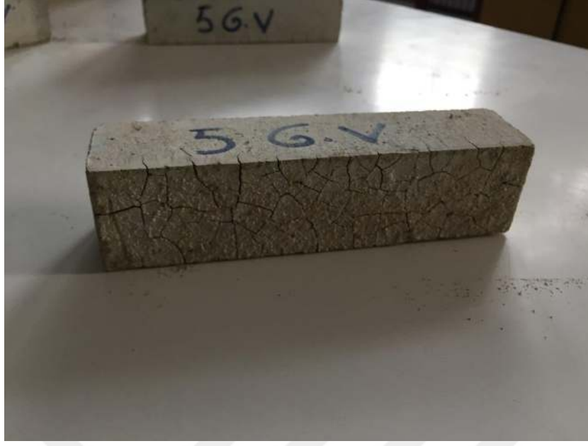
Şekil 4.17. Yüksek sıcaklığa maruz bırakılan numunelerin yakın görünümü
