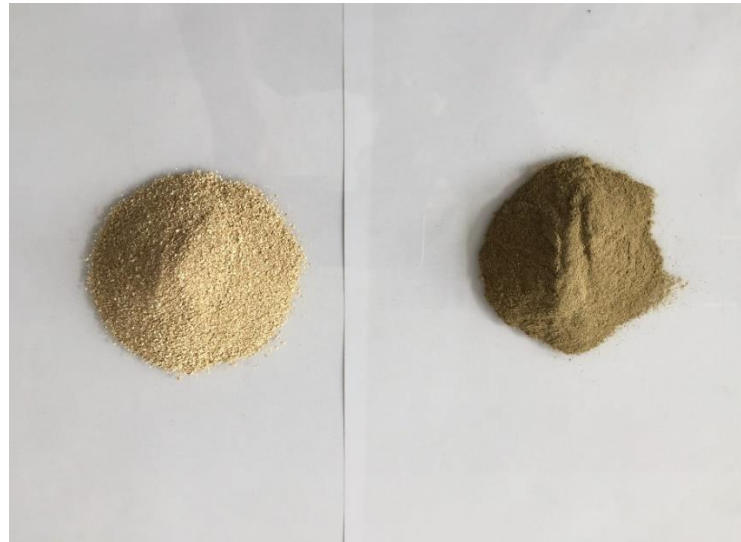
Şekil 4.2. Genleştirilmiş vermikülit ve ham vermikülit
