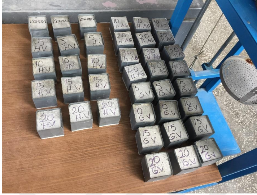
Şekil 4.13. Yan yüzeyleri izole edilmiş küp numuneler
