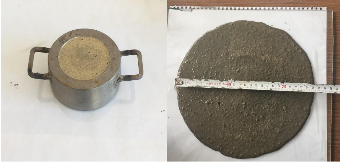
Şekil 4.4. Mini çökme-yayılma çapının ölçümü
