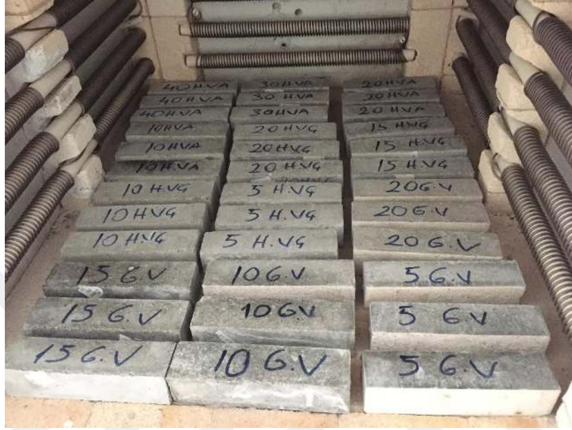
Şekil 4.15. Numunelerin yüksek sıcaklık fırınına yerleştirilmesi
