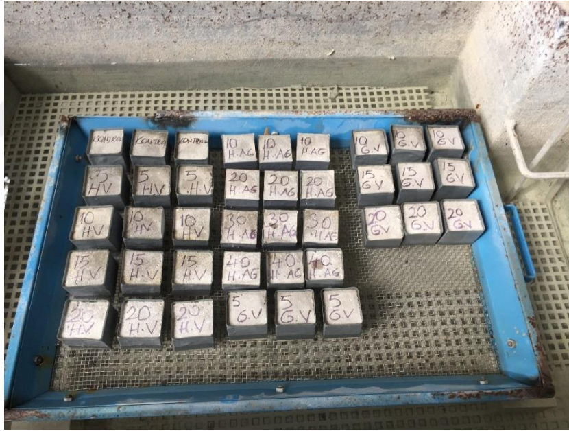
Şekil 4.14. İzole edilmiş küp numunelerin su emmesi
