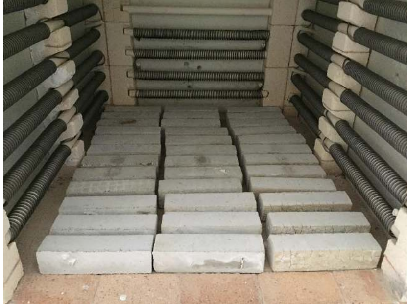
Şekil 4.16. Yüksek sıcaklık uygulamasından sonra numunelerin durumu
