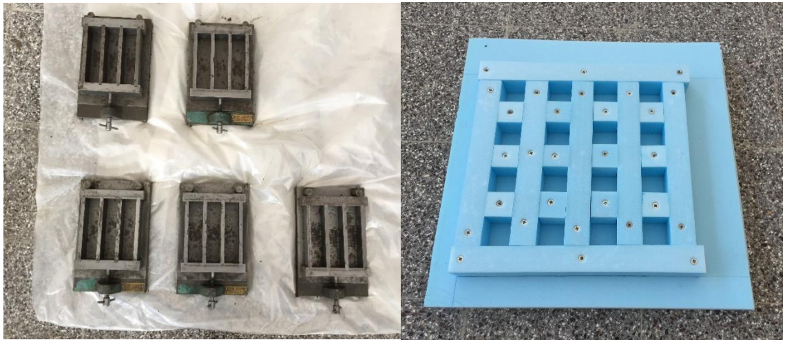
Şekil 4.6. 40x40x160 mm'lik prizmatik ve 50x50x50 mm'lik küp kalıplar
