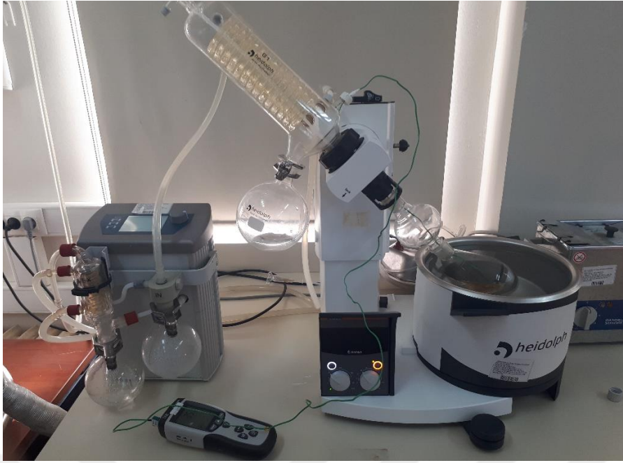
Şekil 12. Vakum döner distilasyon sistemi
