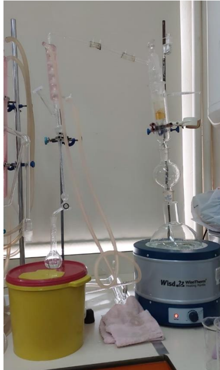
Şekil 13. Alkol tayini için distilasyon düzeneği
