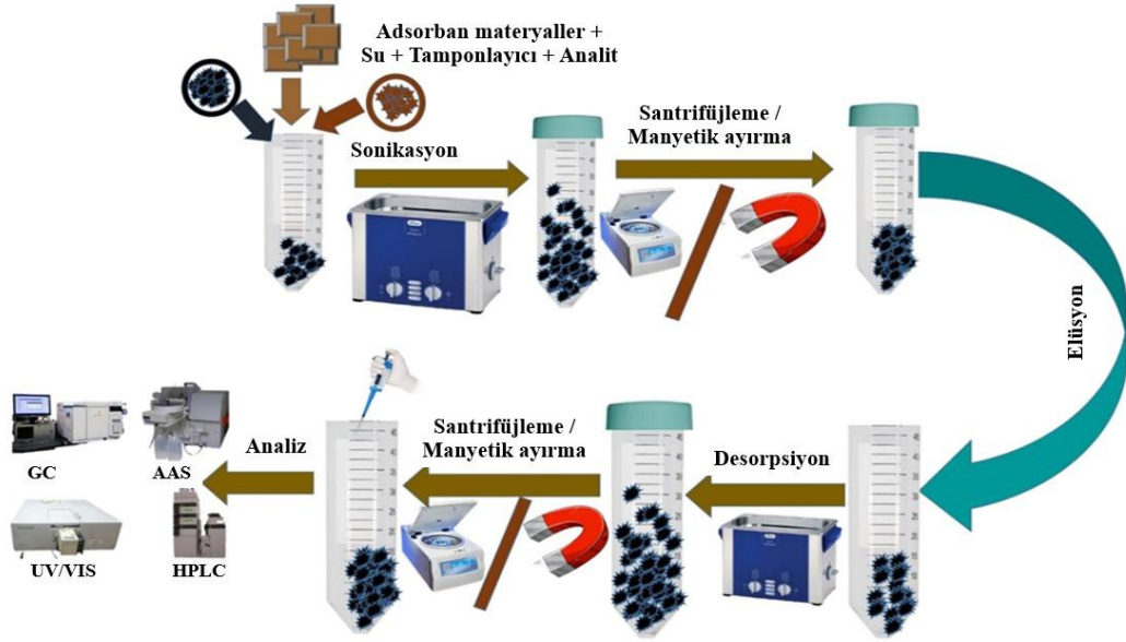
Şekil 7: Katı Faz Mikro-Ekstraksiyon Mekanizması (Jagirani ve Soylak, 2022)
