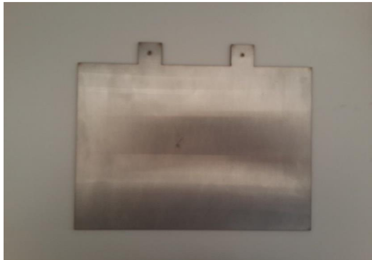
Şekil 3.3 Paslanmaz çelik elektrot (orjinal)
