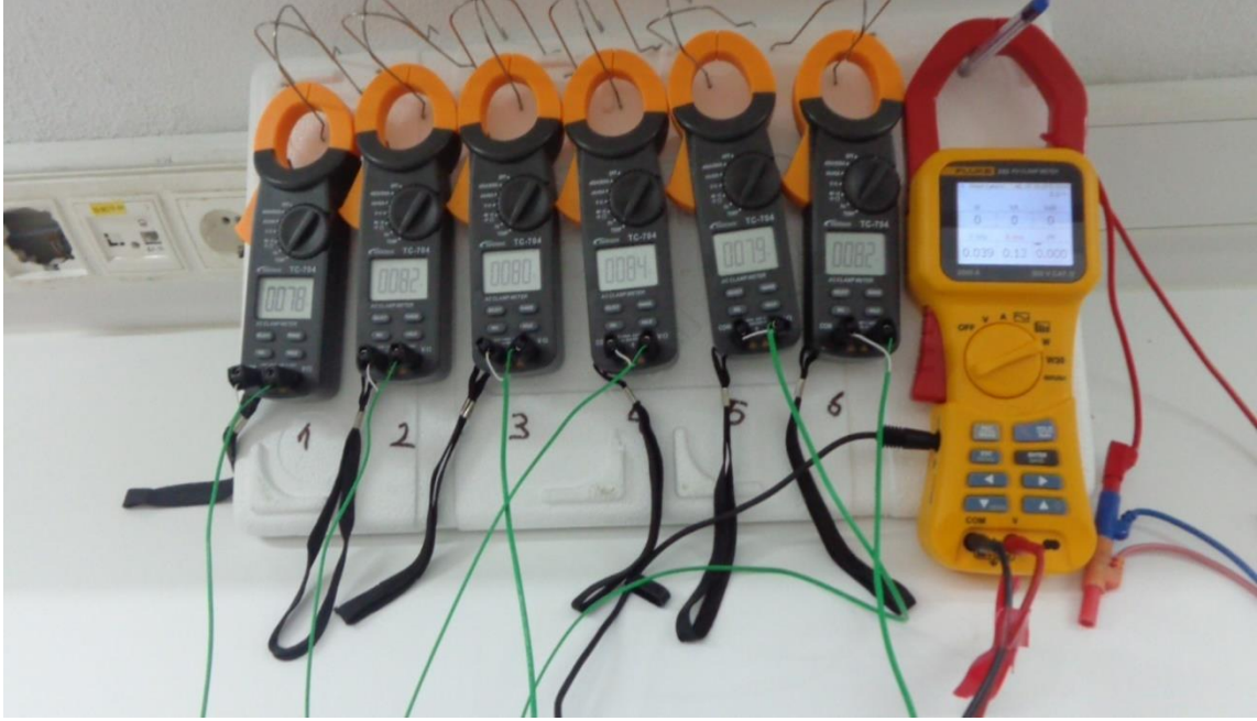
Şekil 3.4 Anlık ölçüm için kullanılan multimetre ve termokupllar (orjinal)
