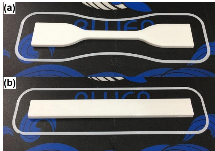
Şekil 2.18: Çekme ve üç nokta eğme testi numunelerinin üretimi.
