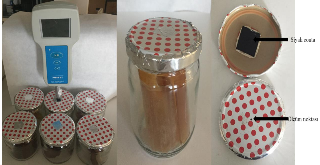
Şekil 3.2. Oksijen tutma kapasitesi ölçümü için kullanılan sistem
