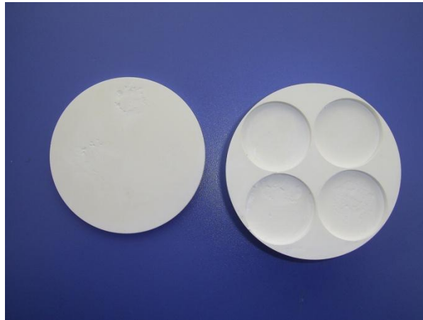
Şekil 3.5. Eritmelerde kullanılan BN kroze
