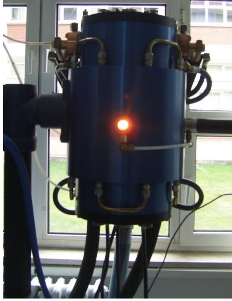
Şekil 3.4. Eritme işlemlerinin yapıldığı fırının resmi
