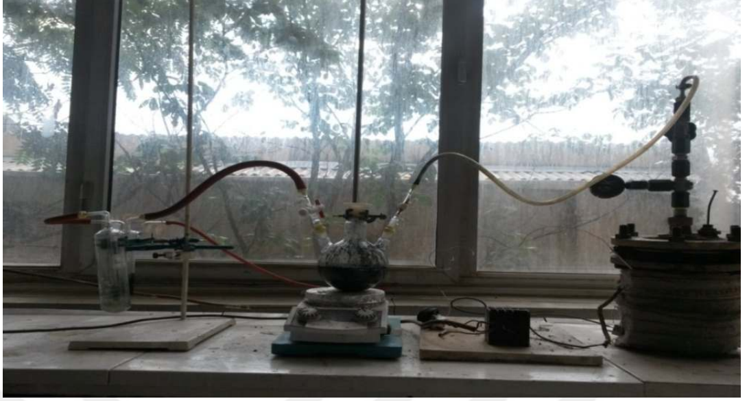
Şekil 4.15. Bulamaç Halindeki Karışımın Sülfürlenmesi Düzenegi
