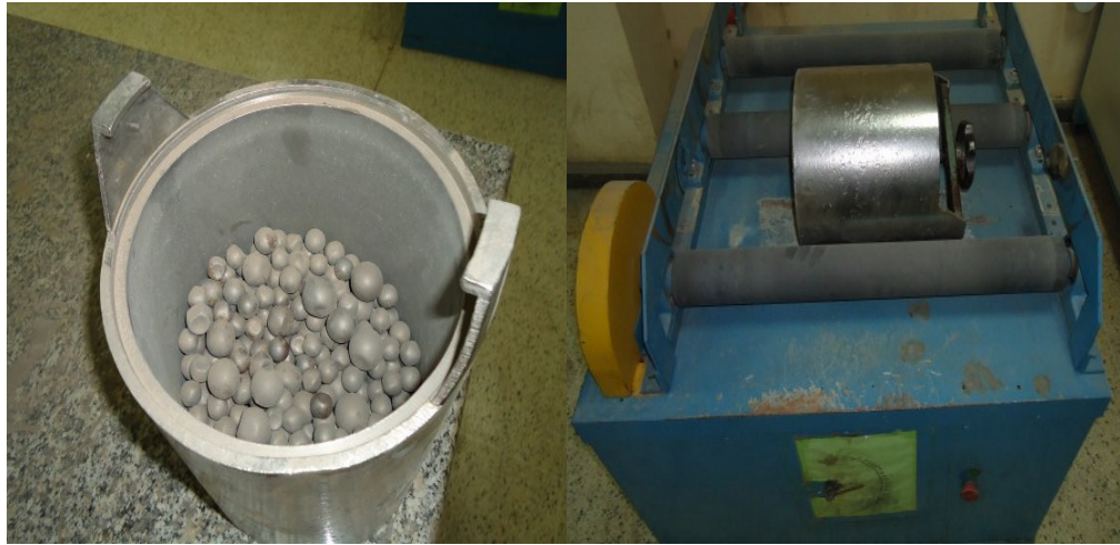
Şekil 4.2 Öğütme deneylerinde kullanılan bilyalı değirmen ve bilyalar
