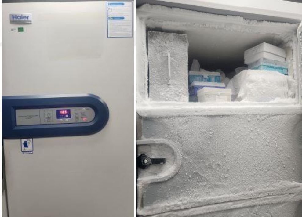
Şekil 3.4: Örneklerin saklandığı -80°C dondurucu (Haier Bio Medical, Model: DW-86L338)
