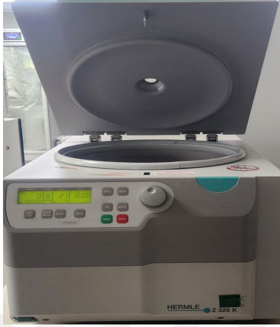
Şekil 3.3: Tükürük örneklerinin santrifüjü için kullanılan Hermle Z326 K santrifüj cihazı
