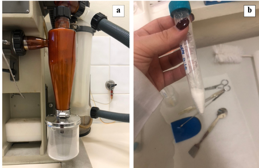
Görsel 4.3. Püskürterek kurutma sonucu elde edilen partiküller (a: Haznede biriken partiküller b: Toplanıp etiketlenen partiküller)
