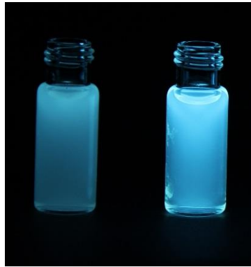
Şekil 4.20: Donör (sol) ve Polimerin (sağ) UV lamba (366 nm) altında fotoğrafı
