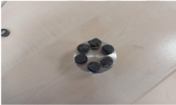
Resim 11.16. Alüminyum kotalar üzerine yerleştirilen numuneler
