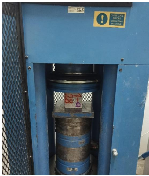
Resim 11.13. Basınç dayanım cihazı ve kırılan bir numunenin kırılma anındaki değeri
