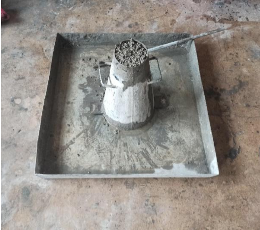
Resim 11.7. Çökme değerinin belirlenmesi
