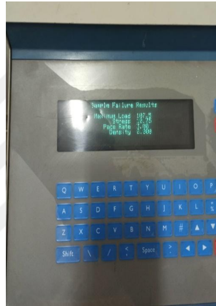
Resim 11.13. Basınç dayanım cihazı ve kırılan bir numunenin kırılma anındaki değeri
