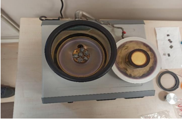
Resim 11.17. Kaplama makinesi ierisine konulan numuneler
