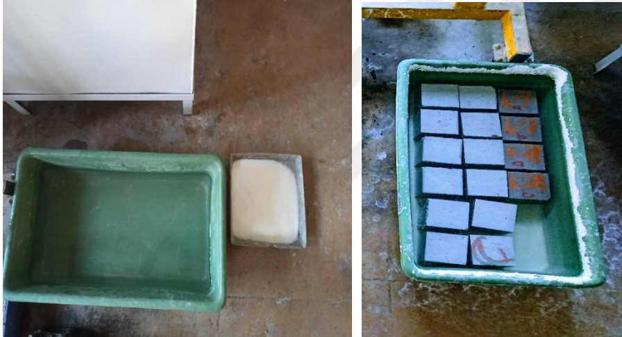
Resim 11.12. Sodyum sülfat çözeltisi ve çözelti içerisindeki numuneler
