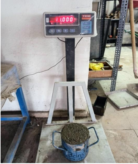
Resim 11.8. Taze betonun deney kovası ile birlikte tartımı
