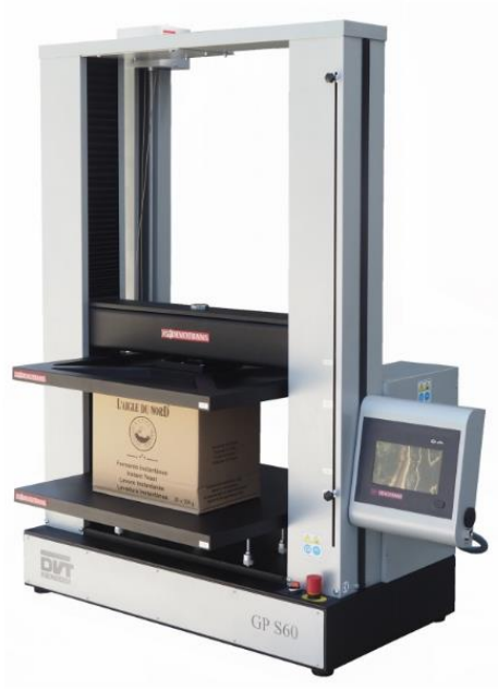
Şekil 2.5. DVT Devotrans kutu ezilme dayanımı test cihazı (Anonim 6 2025)
