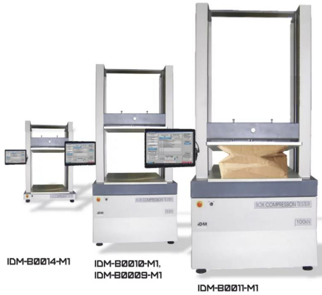
Şekil 2.4. IDM Instruments kutu sıkıştırma test cihazları (Anonim 4 2025)
