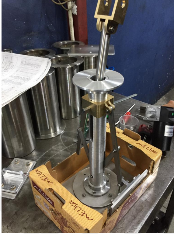
Şekil 3.16. Pabuç montajlı iletim mekanizması
