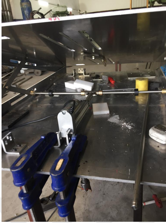
Şekil 3.17. Üst ve alt tabla hareket mekanizması
