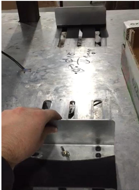
Şekil 3.18. Üst tabla üzerindeki sıkıştırma plakaları
