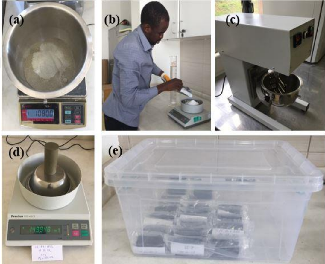
řekil 6.14. Numunelerin hazırlama prosedr: (a) Numunenin olivinle kariřımı, (b) Potasyum hidroksit zltisinin hazırlanması, (c) Elektrikli kariřtırıcı ile kariřtırma, (d) Numunenin hazırlanması (e) Numunelerin muhafaza edilmesi.
