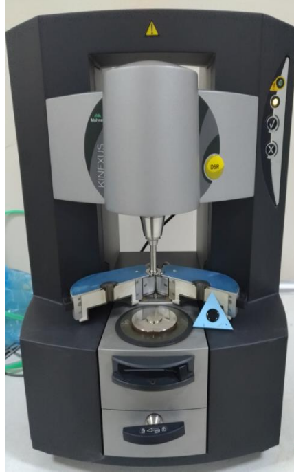
Şekil 3.23 Dinamik kayma (Kesme) reometresi deney (DSR) aleti.
