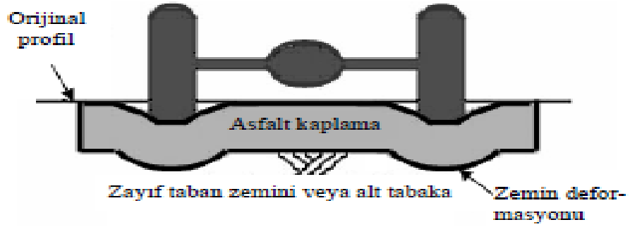
Şekil 3.10 Yapısal tekerlek izi oluşumu.
