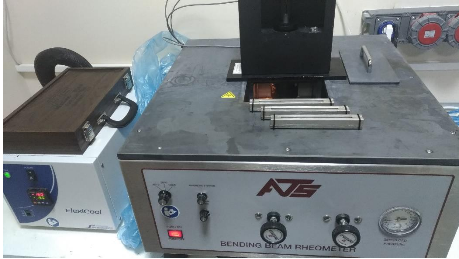
Şekil 3.22 Kiriş eğme reometresi (BBR) deney aleti.
