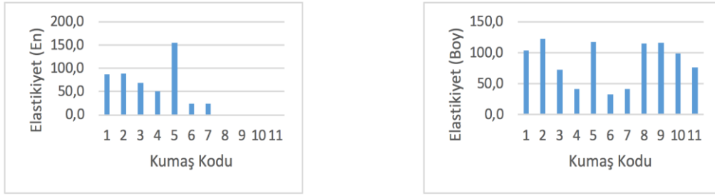
Şekil 4.7: Pretotipleme ve prototipleme aşamasında kullanılan kumaşlara ait elastikiyet ölçümleri
