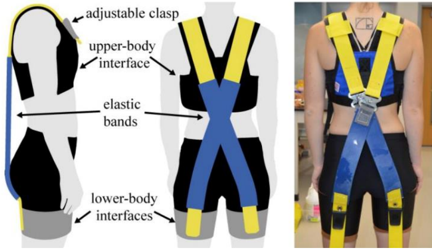
Şekil 2.15: Aktüatörsüz Soft Exosuit tasarımı (Lamers vd. 2017)
