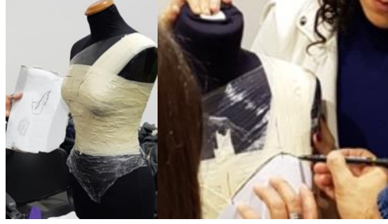
Şekil 2.23: Vücut formunun kopyalanması ile doğrudan kalıp elde etme (Çakmak, 2019)
