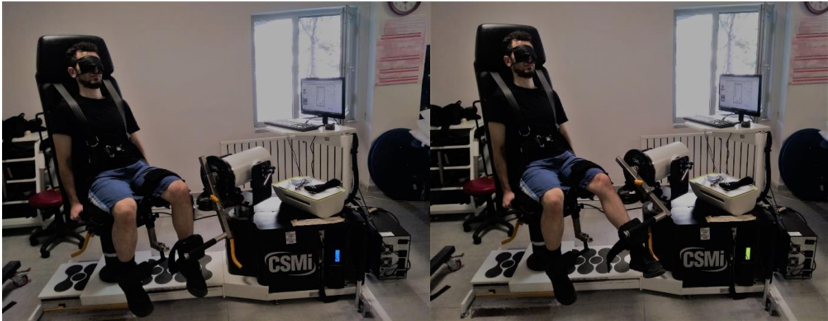
Resim 3.6 Aktif açı tekrarlama testi ölçümü
