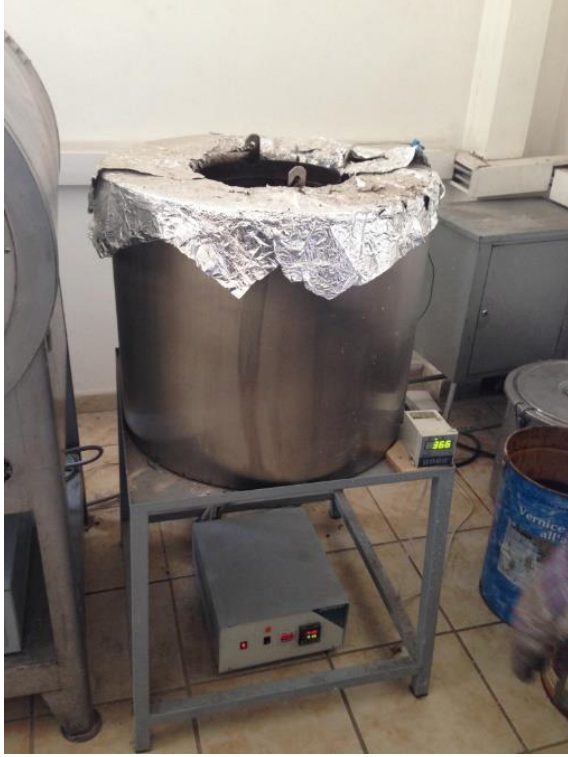
Resim 4.2. Östempereleme ısıl işlemlerinde kullanılan Protherm marka tuz banyosu
