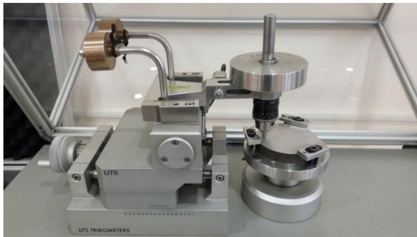
Resim 4.7. Aşınma deneylerinde kullanılan UTS20 tribometre
