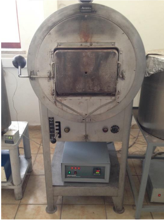
Resim 4.1. Isıl işlemlerde kullanılan Heraeus marka ısı işlem fırını
