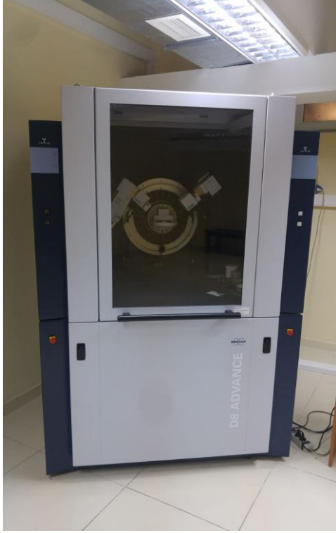
Resim 4.3. Çalışmalarda kullanılan XRD cihazı
