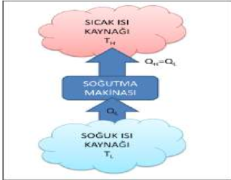
Şekil 3.2. Soğutma Makinası (Ustaoğlu, 2011).
