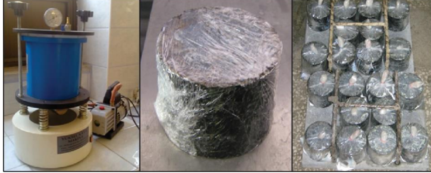
Şekil 4.3. Piknometre ve vakum cihazı, numunelerin koşullandırma işlemi için hazırlanması
