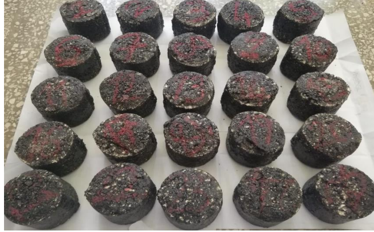
Şekil 4.2. Marshall stabilite ve akma deneyine tabi tutulmuş BSK numuneleri
