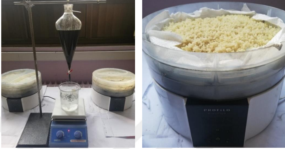
Şekil 3.3. Kapsül üretimi için gerekli olan dehidratör, manyetik ısıtıcılı karıştırıcı, beher ve damlatma hunisi
