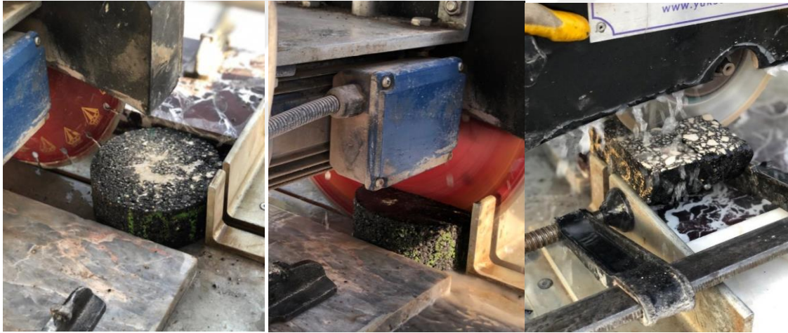
Şekil 5.33. Numunelerin yarım daire şekline getirilmesi ve çentik açılması
