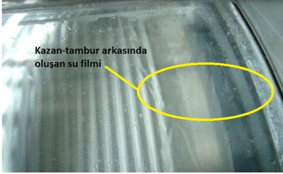
Şekil 1.4 Kazan arka bölgesinde yüksek devirlerde oluşan su filmi
