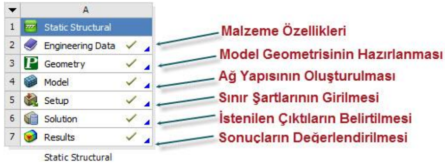
Şekil 3.4 Statik analiz işlem adımları
