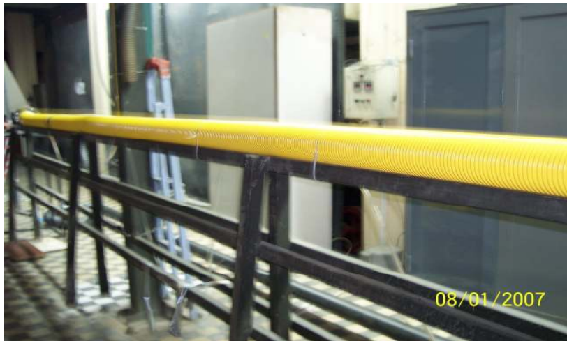
Şekil 4.5 Ondüleli borunun deney tesisatında görünümü
