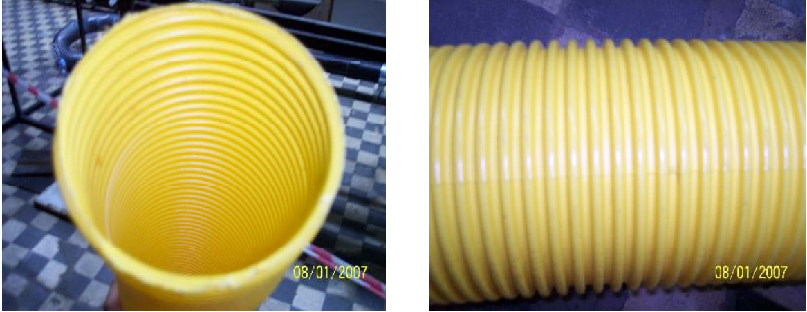
Şekil 4.4 Ondüleli boru iç ve dış yapısı
