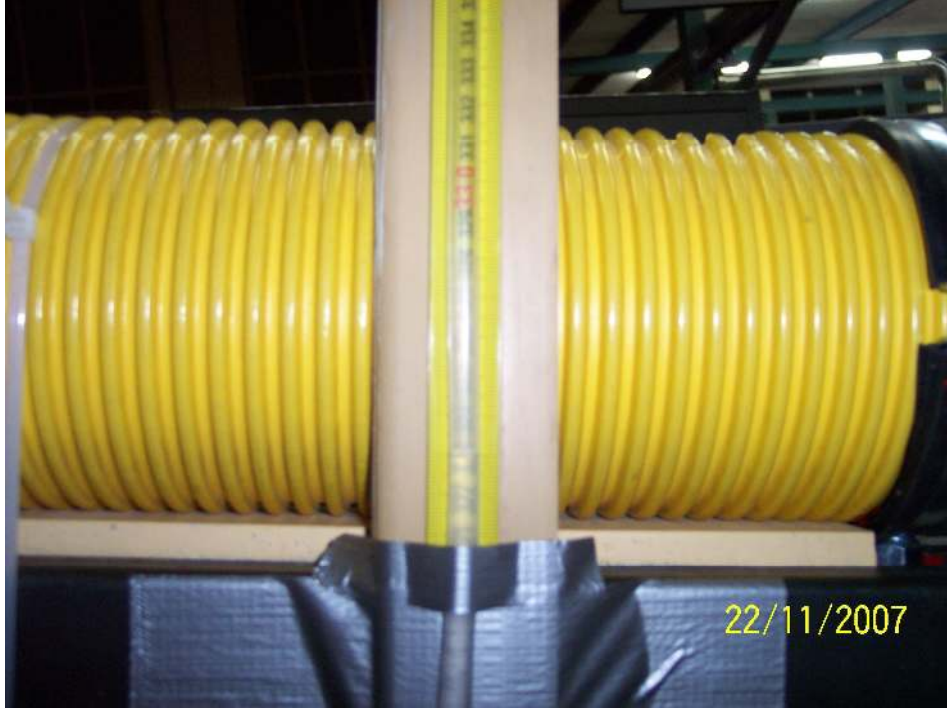
Şekil 4.12 Su seviye yüksekliği ölçüm istasyonu
