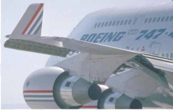
Şekil 7. Boeing 747-400 uçağında kullanılan bükülmüş (canted) uç kanatçık (Faye, Laprete, & Winter, 2002).
