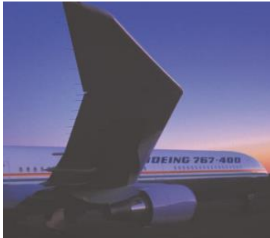
Şekil 8. Boeing 767-400 uçağında kullanılan arkaya eğimli (raked tip) kanat ucu (Faye, Laprete, & Winter, 2002).
