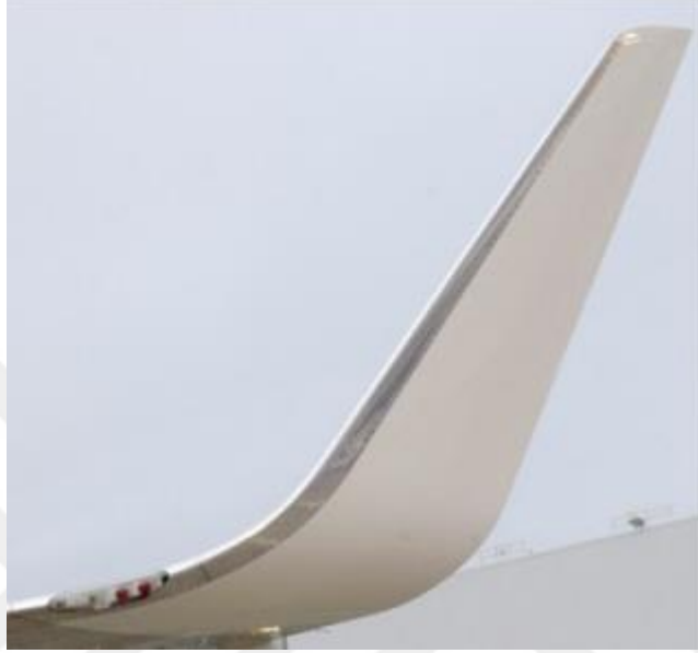
ekil 4. API tarafından Boeing 737NG ailesi iin gelitirilmi yumuak geili u kanatık (McLean, 2005).
