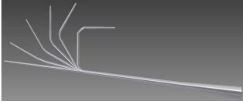
Şekil 12. Farklı kıvrım açıları için C tipi kanat geometrisi (Smith, Lowenberg, Jones, & Friswell, 2012)
