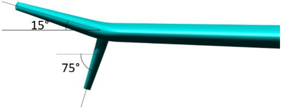
Şekil 18. \Gamma = 15^\circ/-75^\circ değerleri için iki uç kanatçıklı ONERA M6 kanadının geometrisi
