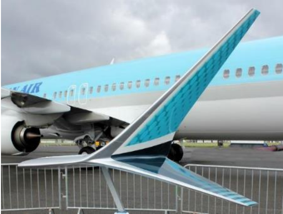
Şekil 6. Boeing ileri teknoloji (AT) uç kanatçık tasarımı (URL-3, 2023)
