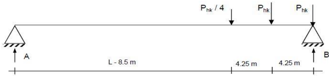
Şekil 2.3 H 30 -S 24 standart kamyon yükünün kesme kuvveti için basit kiriş üzerindeki elverişsiz yerleşimi
