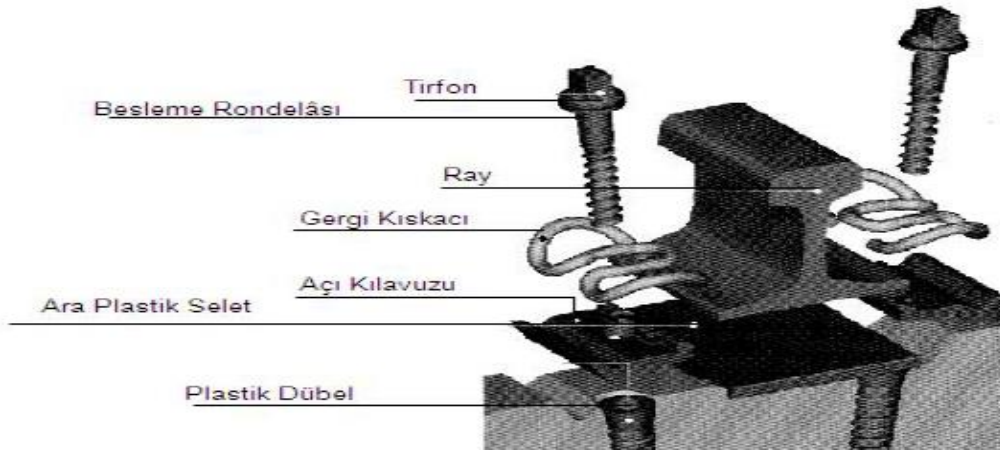
Resim 2.2 HM tipi ray bağlantı elemanları (TCDD 2018).
