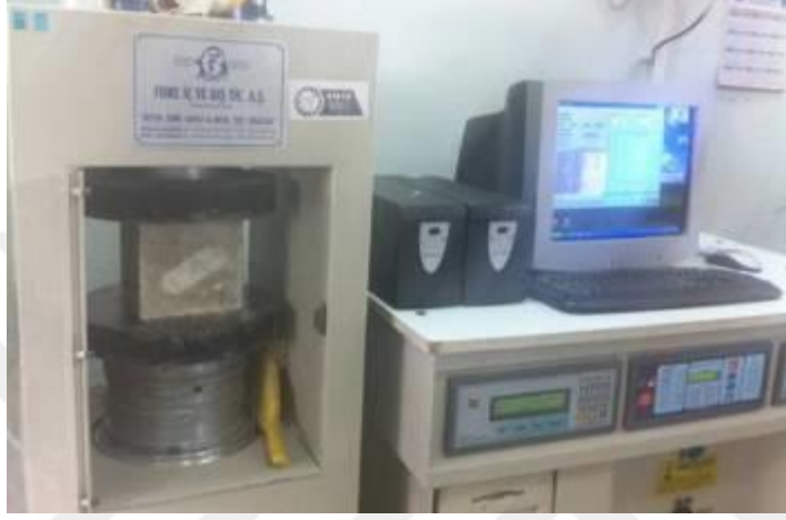
Resim 3.9 Basınç dayanımı deneyinin yapılışı.
