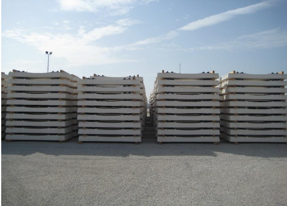
Resim 2.4 Öngermeli monoblok beton travers istif sahası ( İNKOL 2018 ).
