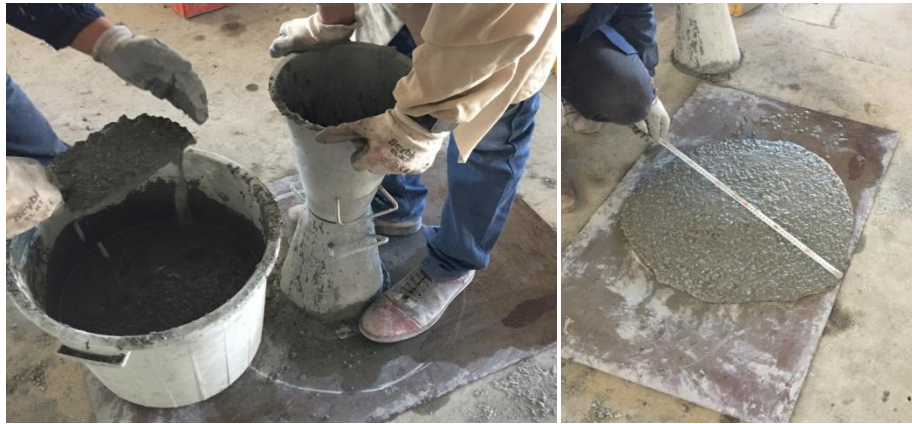
Resim 3.6 Yayılma ve t_{500} süresi ölçümü deneylerinin yapılışı.
