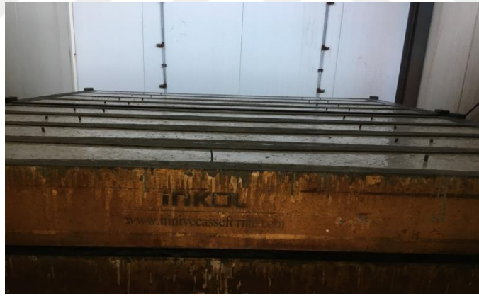
Resim 3.2 Üretilen KYB travers numunelerine buhar kürü uygulaması.
