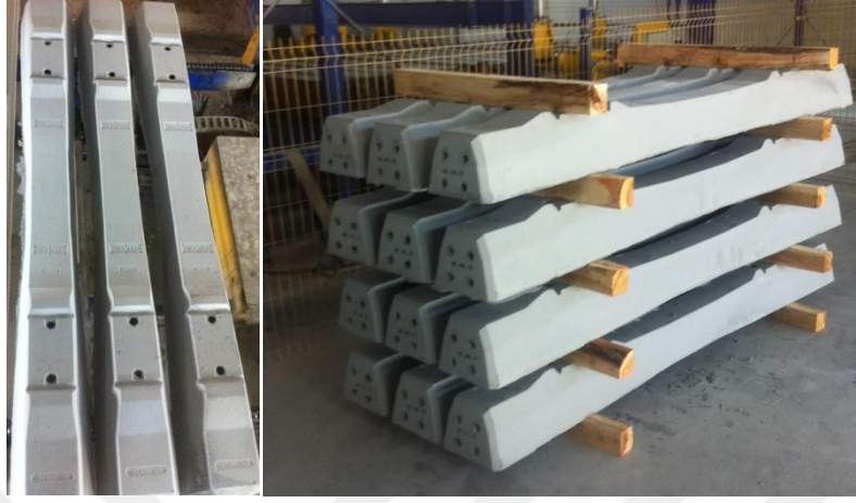
Resim 3.5 KYB kullanılarak üretilen beton travers numuneleri.
