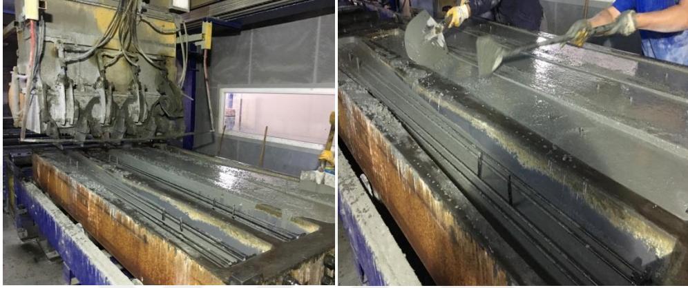
Resim 3.1 KYB travers numunelerinin üretimi.
