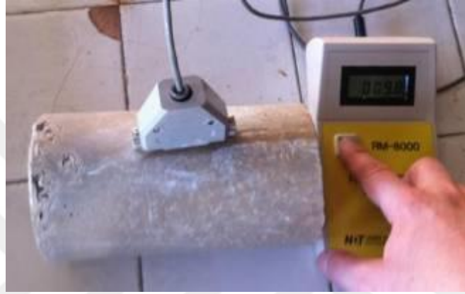
Resim 3.11 Elektriksel özdirenç ölçümü.
