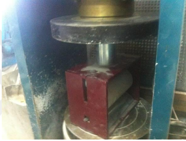
Resim 3.10 Yarmada-çekme dayanımı deneyinin yapılışı.
