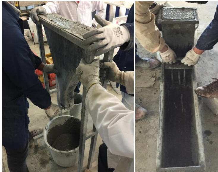
Resim 3.7 V hunisi ve L kutusu deneylerinin yapılışı.
