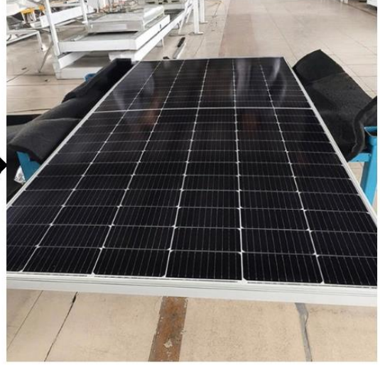
Termal kısmın üzerinde bulunan Fotovoltaik Kısım
