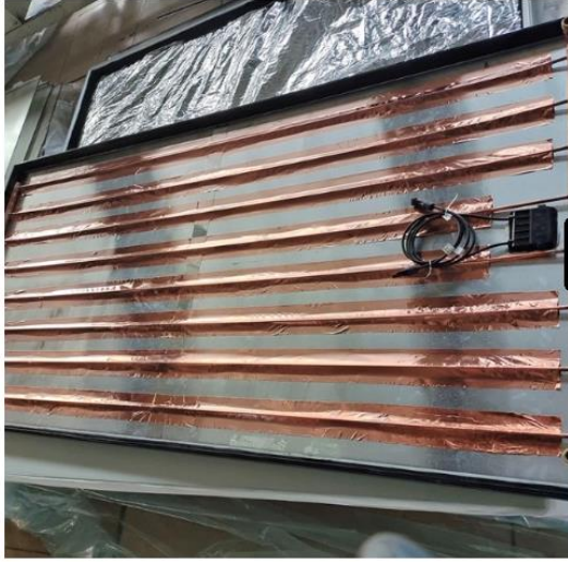
Panelin altında kalan, akışkanın dolaştığı Termal Kısım
