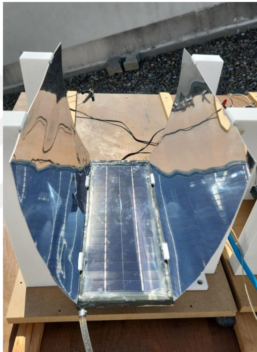
Şekil 1.3: Yoğunlaştırıcı fotovoltaik-termal sistem deney düzeneği
