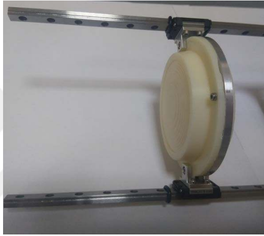
Şekil 2.26 Odak mercek grubun bütünlenmesi
