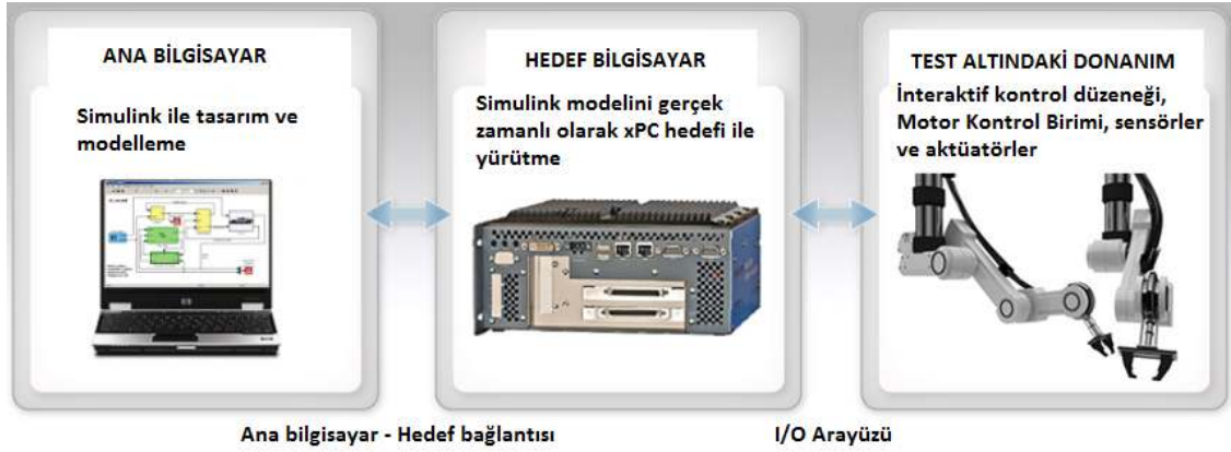
Şekil 3.4 Simulink® gerçek zamanlı test düzeneği [19]
