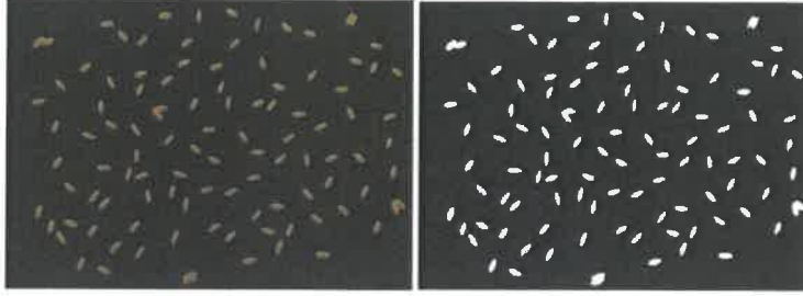
Şekil 2.16. Örnek görüntü ve otsu algoritması uygulanmış hali
