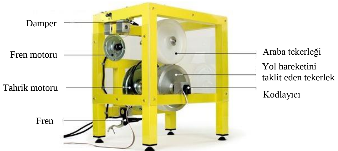
Şekil 2.10 : ABS deney sistemi bileşenleri.
