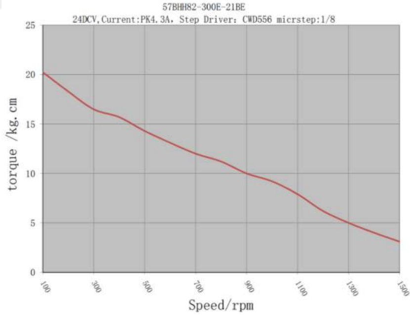
Şekil 3.9 Nema23 hız/tork grafiği.
