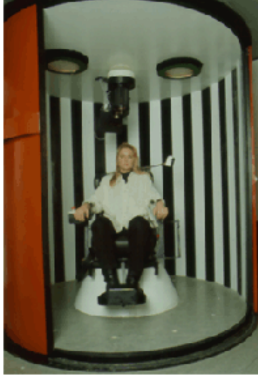
Şekil 2.7 Tüm görsel alanı uyaran optokinetik silindir [22]
